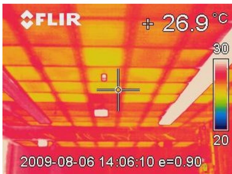
Abbildung 5-5: Thermografie-Aufnahme der Kühldecke in Raum 319 kurz nach dem Einschalten der Kühldecke
