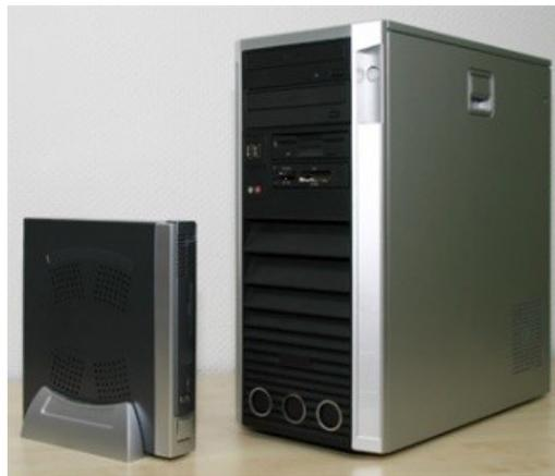
Abbildung 6-21: Vergleich eines Thin-Clients (ca. 0,9 kg) mit einem herkömmlichen Desktop PC (ca. 8,5 kg)
