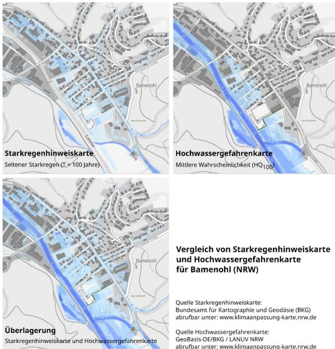
Abbildung 1: Vergleich und Überlagerung von Starkregenhinweiskarte und Hochwassergefahrenkarte.
