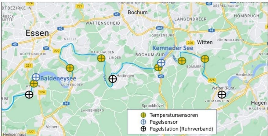
Abbildung 3: Darstellung der für das ABOT-Projekt installierten IoT-Sensorik zur Prognose von Fischwanderungen
