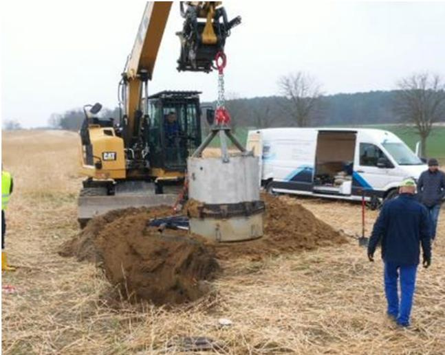
Abb. 3: Gewinnung eines Bodenkörpers auf einem Acker in Brandenburg.
