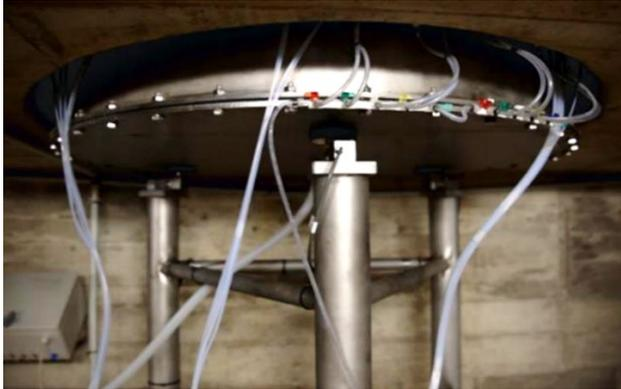
Abb. 5: Lysimeter (eingebauter Bodenkörper) von unten, mit Schläuchen (an Saugkerzen) zur Beprobung
