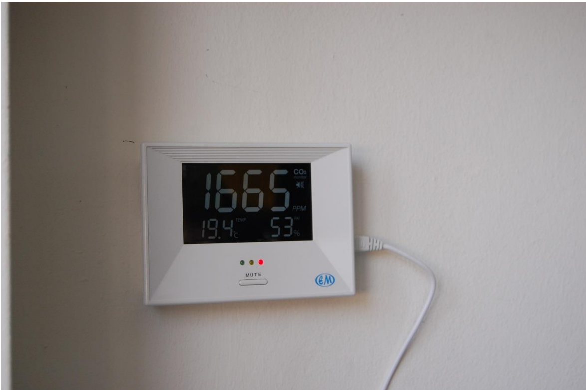
Abbildung C. CO 2 -Messgerät der Firma Electro-Mation mit dem Modell EMAQ-31 in Klasse 2
