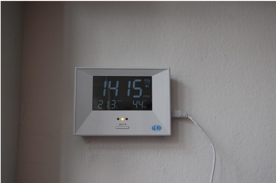
Abbildung A. CO 2 -Messgerät der Firma Electro-Mation mit dem Modell EMAQ-31 in Klasse 1
