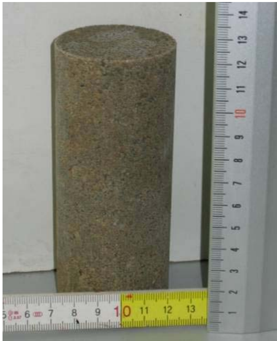
Bild 5-15 Gefrorene Probe aus Rheinsand
