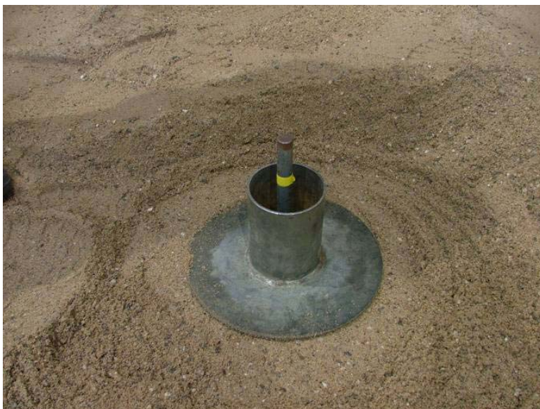
Bild 5-19 Versuchsaufbau zur Entnahme von Bodenproben mit dem Ausstechzylinder
