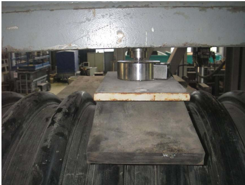
Bild 4-11 Teilbelastung des PE-Rohres über zwei Rippen
