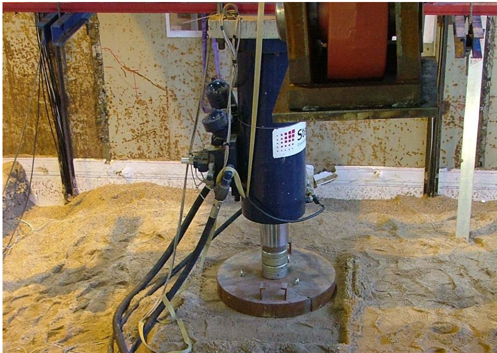
Bild 3-15 Lasteinleitungskonstruktion beim Lastfall „Einzelrad statisch - Bauzustand“
