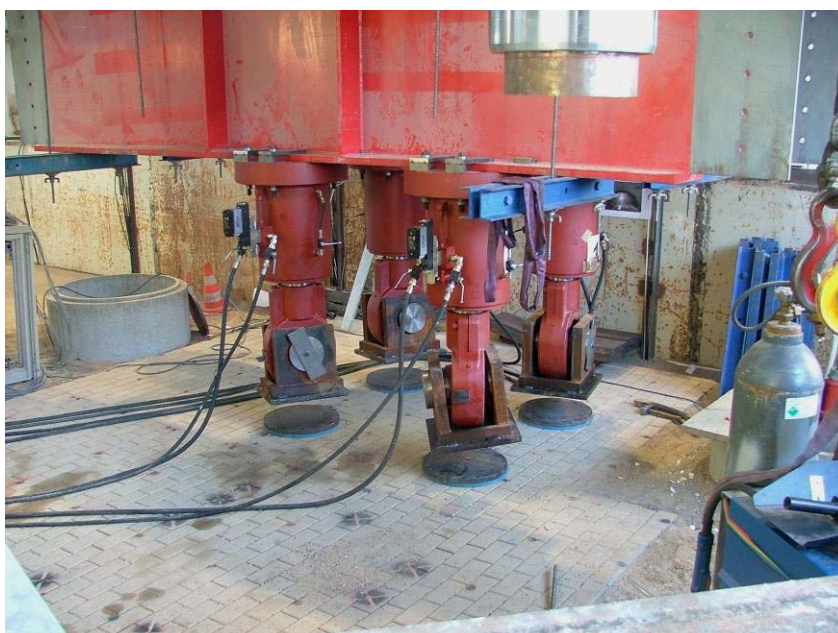
Bild 3-13 Lasteinleitungsstruktur für den Lastfall „Radgruppe statisch“
