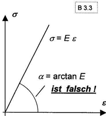
In Bild 3.3 ist die in fast allen Lehrbüchern der Technischen Mechanik angeführte Angabe „ $\arctan E$ “ für den Steigungswinkel der Hookeschen Geraden dargestellt:
