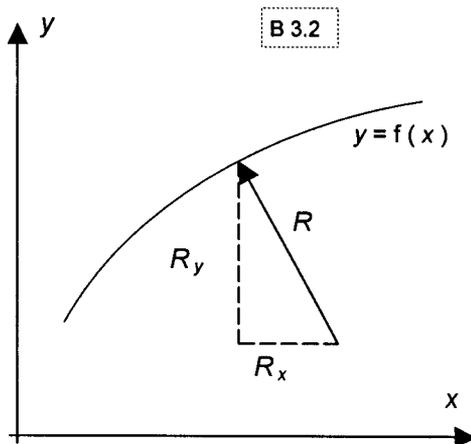
Aus Bild 3.2 ist auch nochmals anschaulich sofort zu erkennen, dass für den Fall *ungleicher* Einheiten von  $x$  und  $y$  der Krümmungsradius nicht berechnet werden kann; denn es gilt nach Pythagoras
