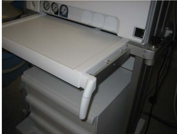
Abb. 5.45 Narkosegerät: Ergonomische geformte Handgriffe unterstützen die Gebrauchstauglichkeit für das Manövrieren von schweren Medizinprodukten
