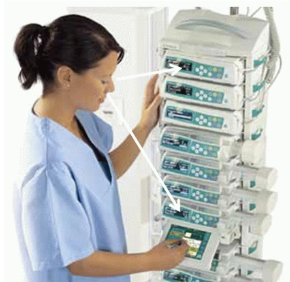
Abb. 4.21 Unterschiedliche Winkel der Blickneigungen von Skalenanzeigen bei Zusammenstellung mehrerer baugleicher Geräte (Bild- und Hersteller-nachweis vgl. Anhang)
