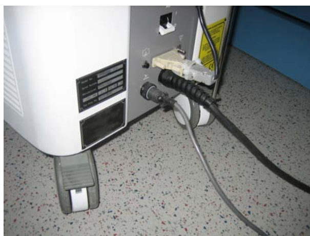
Abb. 5.46 Es ist vorhersehbar, dass der Anwender die Stecker vor dem Transport nicht auskuppelt. Ein Abscheren ist beim Touchieren leicht möglich, insbesondere wenn die hervorstehenden Teile nicht im Sichtfeld liegen.
