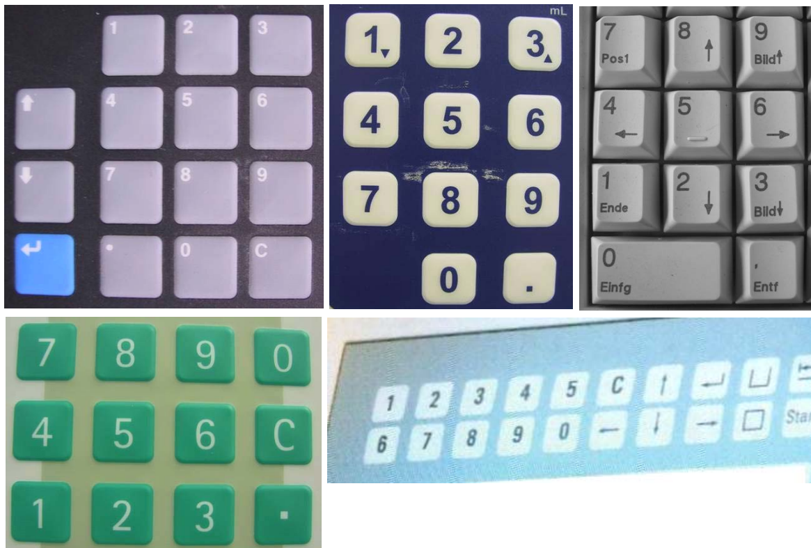
Abb. 5.35 Zehnertastaturen mit unterschiedlichem Layout erhöhen die Wahrscheinlichkeit, dass insbesondere erfahrene Anwender Eingabefehler machen
