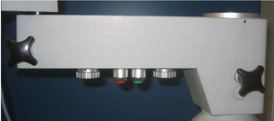
Abb. 5.58 Eine Beschriftung der Stellteile unterstützt die Erinnerung an die Funktionen
