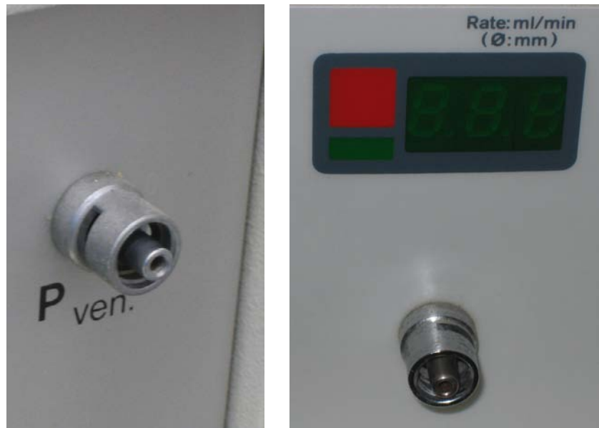
Abb. 5.1 Anschlüsse für verschiedene Medien, für Messungen und Dosierungen sollten geometrisch so gestaltet sein, dass eine Verwechslung ausgeschlossen ist
