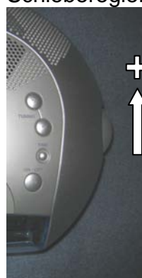
Abb. 9.7 Natürliche mappings können konkurrieren. Hier kann ein rechts hervorstehender Lautstärkereger sowohl als Drehsteller als auch als Schieberegler interpretiert werden. Beide Interpretationen führen zu entgegengesetzten Erwartungen der Betätigungsrichtung für die Erhöhung der Lautstärke.
