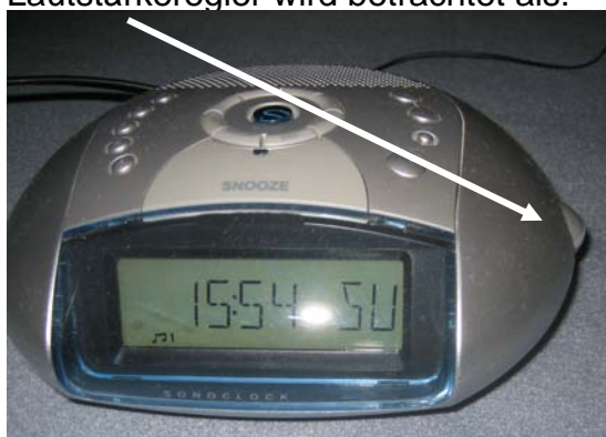
Abb. 9.7 Natürliche mappings können konkurrieren. Hier kann ein rechts hervorstehender Lautstärkereger sowohl als Drehsteller als auch als Schieberegler interpretiert werden. Beide Interpretationen führen zu entgegengesetzten Erwartungen der Betätigungsrichtung für die Erhöhung der Lautstärke.
