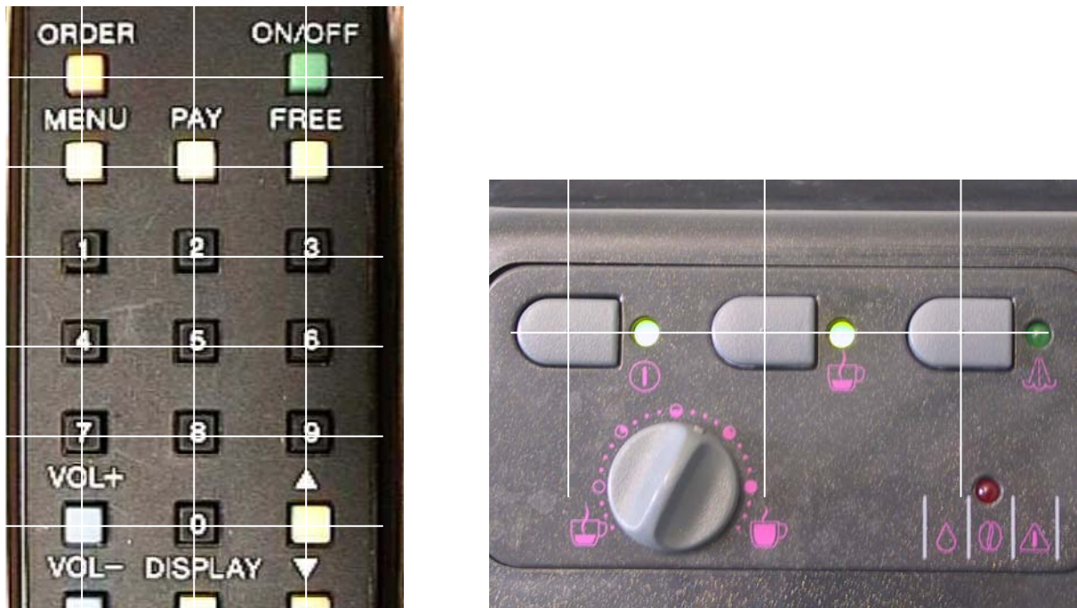
Abb. 9.6 Stellteile für sehr unterschiedliche Funktionen sollten möglichst einfach zu unterscheiden sein. Für Entwickler und für die Fertigung sind Gleichartigkeit und feste Raster/Abstände einfacher und damit günstiger zu entwerfen und zu fertigen. Für Anwender können Handlungsfehler die Folge sein.
