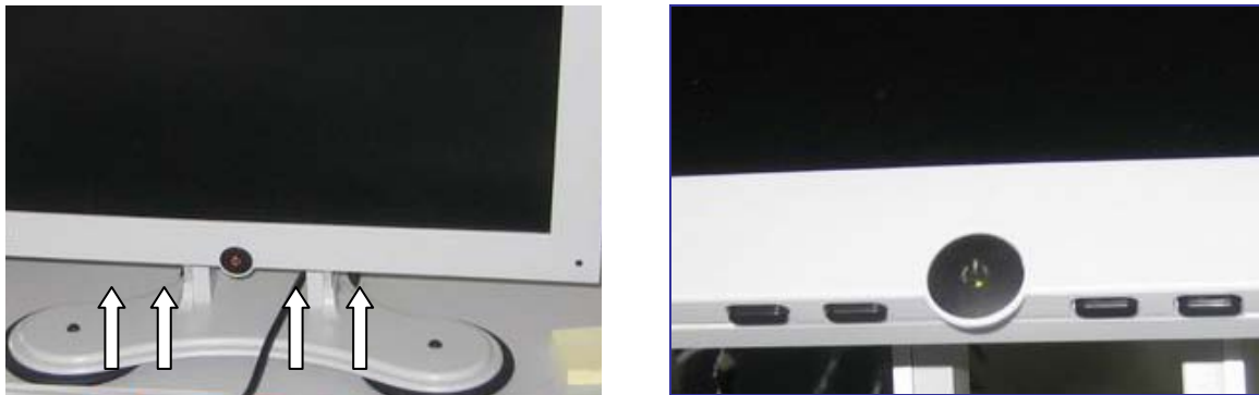
Abb. 5.28 Verdeckte Tasten ohne Beschriftung sind für erfahrene Anwender unproblematisch. Andere Anwender können Schwierigkeiten haben, sie zu finden und richtig zu benutzen.
