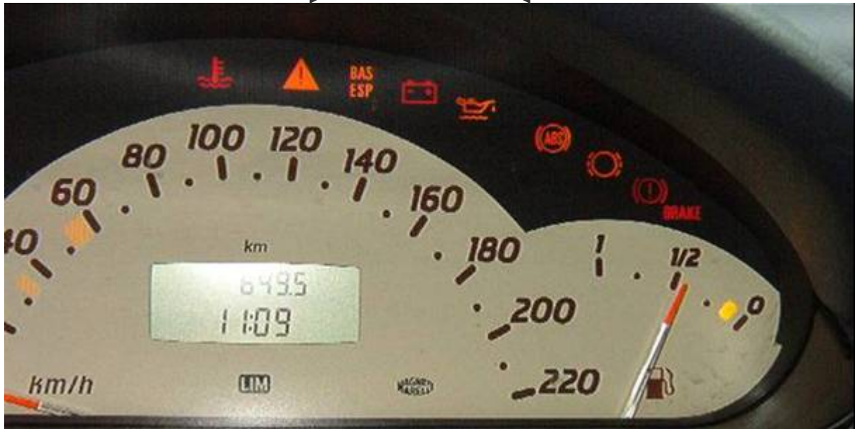
Abb. 9.9 Normalerweise haben Skalen für quantitative Größen ihren Nullpunkt oder den Minimalwert links oder unten. Hier werden zwei gegenläufige Skalen unmittelbar nebeneinander eingesetzt. Die mentale Umsetzung des geläufigen mentalen Modells auf die inverse Funktionalität kann nur durch einen bewussten Prozess stattfinden und ist fehleranfällig.
