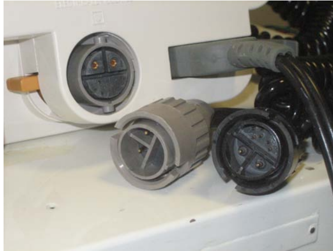
Abb. 5.64 Zwei Steckeralternativen an einem Medizinprodukt die nahezu identische T-förmige, mechanische Kodierungen haben und sich nur in der Farbe und den dünnen Kontaktstiften unterscheiden, können insbesondere in zeitkritischen Situationen leicht verwechselt werden. Vorherzusehender, erhöhter Krafteinsatz kann das Medizinprodukt unbrauchbar machen. Foto: K. Henning, Münster
