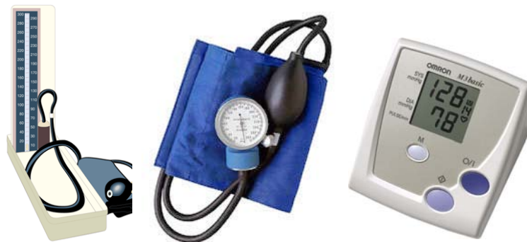
Abb. 4.3 Blutdruckmessgeräte als Beispiele für analoge und digitale Skalenanzeigen (Bild- und Herstellernachweis vgl. Anhang)
