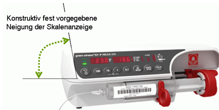
Abb. 4.20 Beispiel einer Infusionspumpe mit konstruktiv fest vorgegebener Neigung einer Anzeige (Bild- und Herstellernachweis vgl. Anhang)
