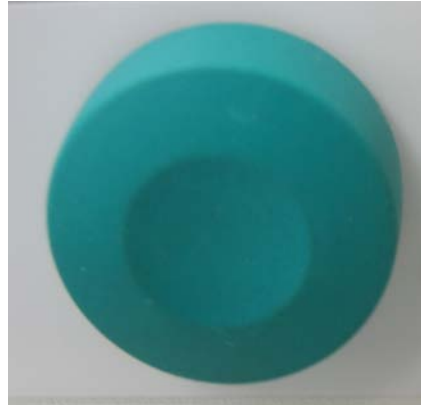
Abb. 5.30 Die Vertiefung auf dem Knopf des Drehgebers fordert zum Drücken auf. Drücken dient bei diesem Stellteil der Bestätigung einer Verstellung.
