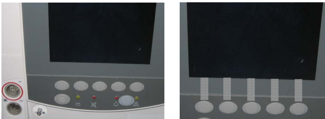
Abb. 5.38 Dem negativen Effekt der Parallaxe kann entgegengewirkt werden, indem optische Mittel die Zuordnung von Stellteil und Anzeige/Information erleichtern. Diese Mittel können graphische Verbindungen, Besonderheiten in der Formgebung oder der auch Schattenwurf von Vertiefungen (Achtung, wirkt nur bei gerichtetem Licht) sein.
