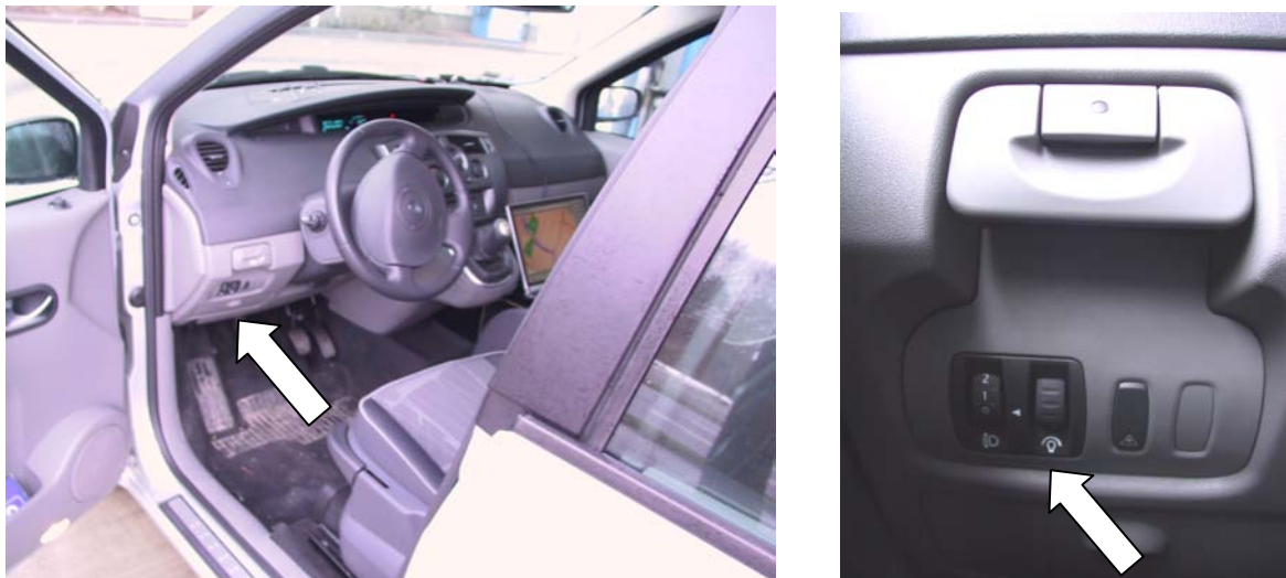
Abb. 9.5 Das Stellteil für die Beeinflussung der Tachobeleuchtung ist weit entfernt vom Tacho untergebracht. Ein Mietwagenfahrer, der das Fahrzeug nicht gut kennt, ist auf Kompatibilität angewiesen, will er nicht die Gebrauchsanweisung lesen.
