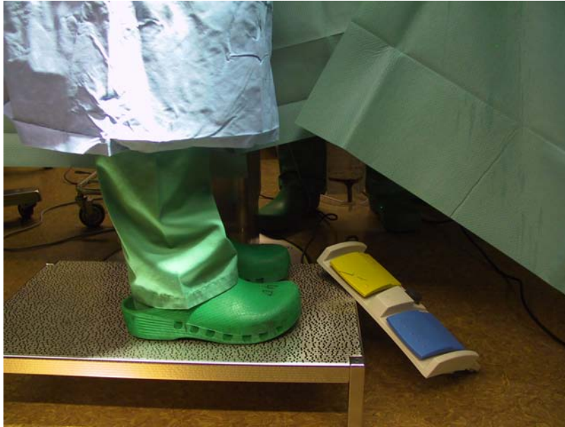
Abb. 5.51 Fußschalter auf Podesten engen die Standfläche ein und können herabfallen. Werden mit solchen Fußschaltern kritische Funktionen gesteuert, können sich beim Betrieb solcher Einrichtungen auf dem Podest erhöhte Risiken ergeben.
