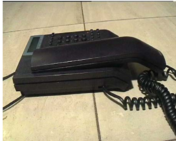
Abb. 5.57 Das Telefonhörererkabel lässt den Hörer nicht in die horizontale Position kommen. Damit wird vom Hörer nicht der Taster betätigt, der das Auflegen signalisiert. Das Telefon verbleibt deshalb weiterhin im Zustand des Anrufes und der Apparat erscheint nach außen als besetzt und ist nicht erreichbar.
