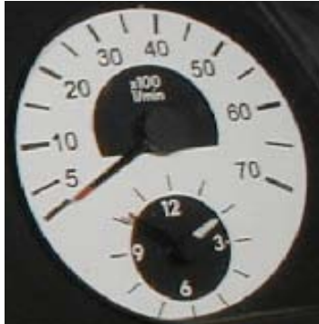
Abb. 9.10 Der Helligkeitskontrast des Zeigers zum Hintergrund ist nicht ausreichend. Der Stundenzeiger ist nicht zu erkennen. (www.baddesigns.com)
