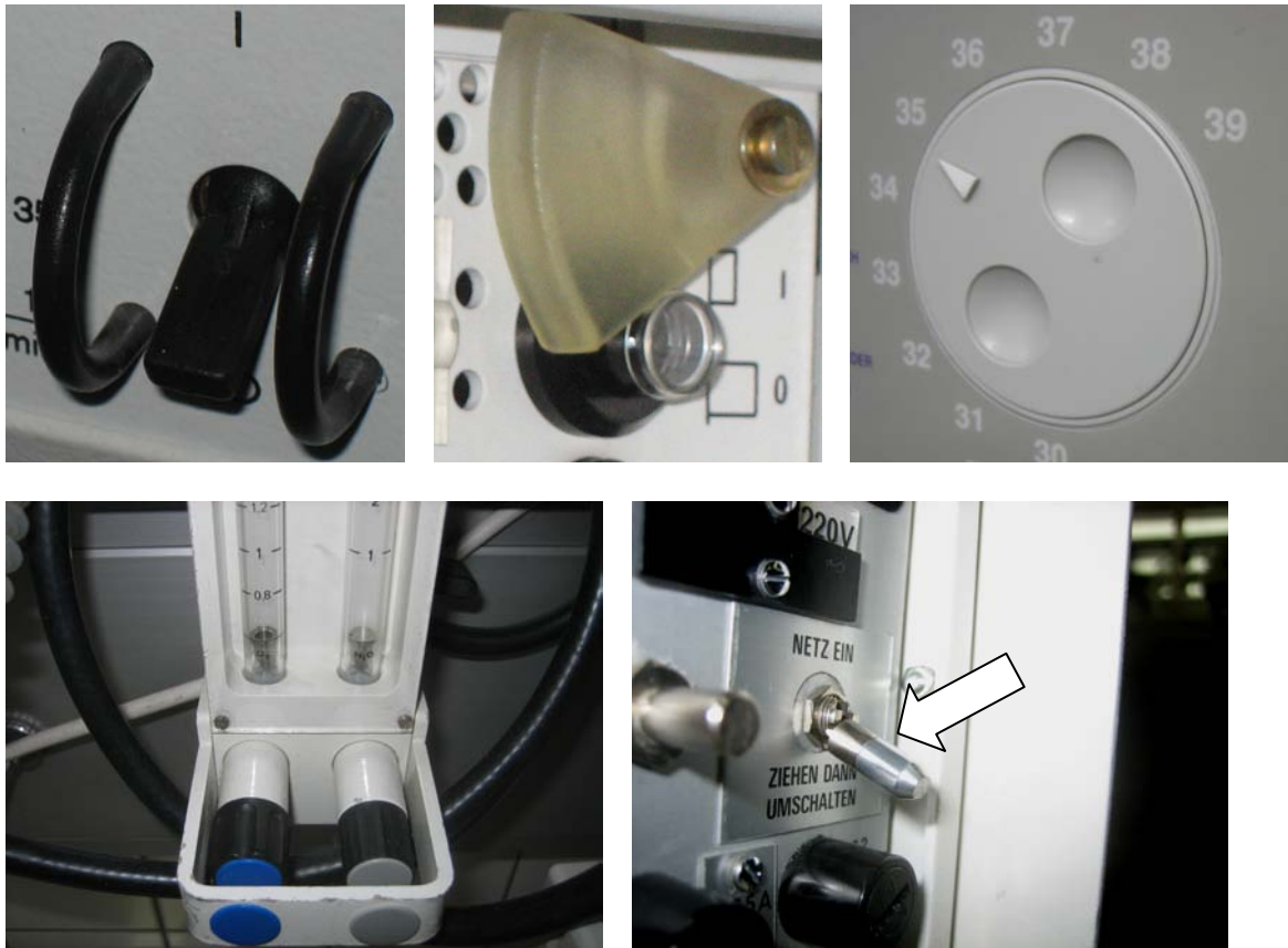
Abb. 5.67 Durch Hilfsmittel oder durch Gestaltung lassen sich kritische Stellteile vor versehentlicher Betätigung schützen. Achtung: Ein nicht selbsterklärender Verstellschutz (s. Pfeil) kann leicht zerstört werden, insbesondere wenn das Stellteil nicht im Sichtfeld des Anwenders liegt (zum Beispiel auf Rückseite des Medizinproduktes).
