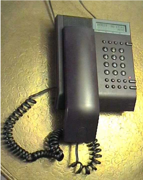
Abb. 5.57 Das Telefonhörererkabel lässt den Hörer nicht in die horizontale Position kommen. Damit wird vom Hörer nicht der Taster betätigt, der das Auflegen signalisiert. Das Telefon verbleibt deshalb weiterhin im Zustand des Anrufes und der Apparat erscheint nach außen als besetzt und ist nicht erreichbar.
