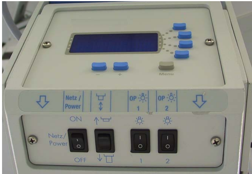
Abb. 5.23 Der Kontrast zwischen Grundfarbe und Kennzeichnungsfarbe muss bei allen vorkommenden Beleuchtungsbedingungen ausreichend sein
