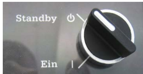
Abb. 5.7 Prinzipbeispiel: Symbole, die nicht allen Anwendern verständlich sind, müssen durch Beschriftungen erklärt werden
