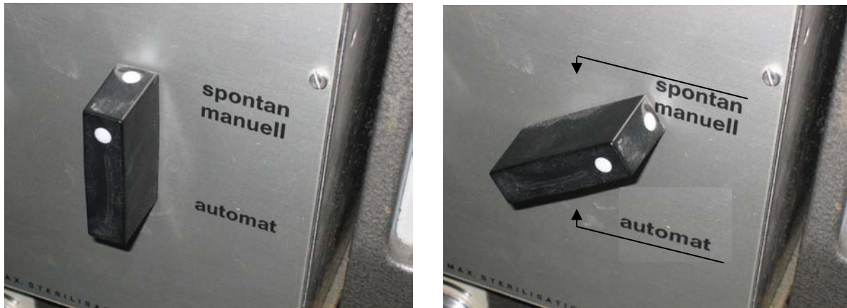
Abb. 5.13 Ein Umschalter sollte eindeutige Kennzeichnung und Rastungen der Schaltpositionen besitzen, um versehentliche Zwischenstellungen (linkes Foto) zu vermeiden
