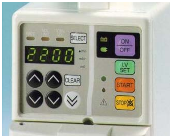
Abb. 5.72 In ostasiatischen Ländern wird Rot als Farbe der Freude und nicht als Kennzeichnung von Gefahr verstanden. In anderen Kulturkreisen kann diese Farbwahl jedoch Handlungsfehler provozieren.
