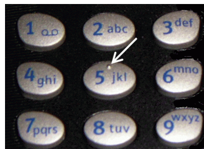
Abb. 4.28 Taktile Anzeige zur Unterstützung der „blinden“ Eingabe über eine Telefontastatur
