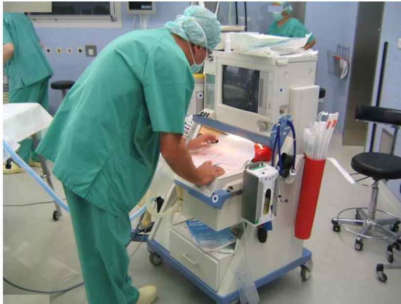
Abb. 5.49 Gebrauchstauglichkeit verlangt eine schnelle Anpassbarkeit an die stehende oder sitzende Körperstellung. Wichtig für die Sitzposition ist die Möglichkeit, die Knie unter der Schreibplatte positionieren zu können.
