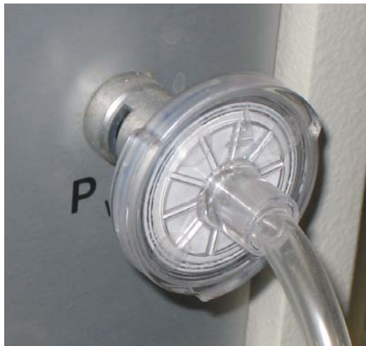
Abb. 5.18 Anschlüsse sollten so gekennzeichnet werden, dass sie aus der Arbeitsposition gut ablesbar sind
