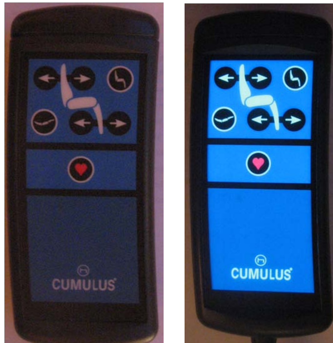
Abb. 5.22 Fernsteuerung: Wichtige Kennzeichnungen wie der Indikator für die Position eines Stellteiles sollte so beschaffen sein, dass er bei üblicher Beleuchtung gut sichtbar ist. Gerade bei stark wechselnden Helligkeiten (zum Beispiel im OP) erhöht die Hinterleuchtung die Gebrauchstauglichkeit.
