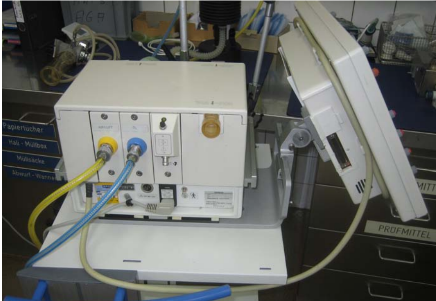
Abb. 4.22 Kippbare Anzeige, um die Neigung in Bezug auf die Sehachse optimieren zu können (Bild- und Herstellernachweis vgl. Anhang)
