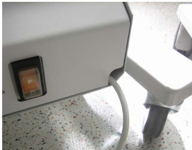
Abb. 5.66 Stellteile ohne Schutz können versehentlich betätigt werden
