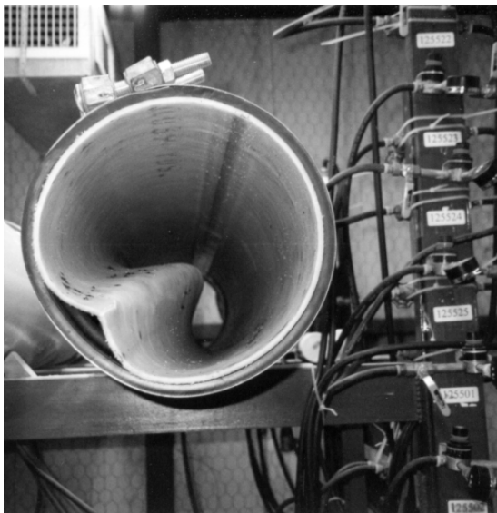
fig 11a lange termijn kniktest uit USA op een kousliner
