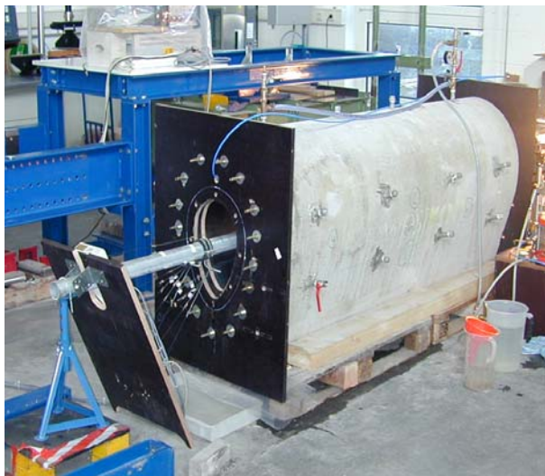
fig 15a kniktest op een lange HDPE liner als lange termijntest
