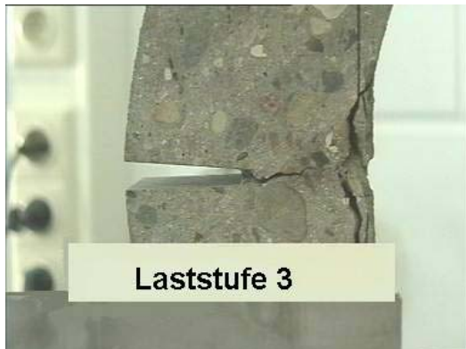
fig 17a betonmonster uit nieuwe betonbuis bij ca. 30% van de draagkracht
