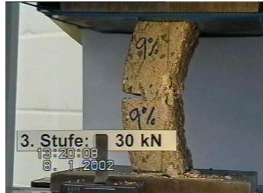
Fig 17b betonmonster uit oude betonbuis bij ca. 30% van de draagkracht
