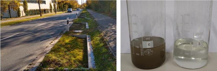
Abb. 3: Testfelder in Münster (l.), ungefilterter und gefilterter Straßenabfluss (r.)
