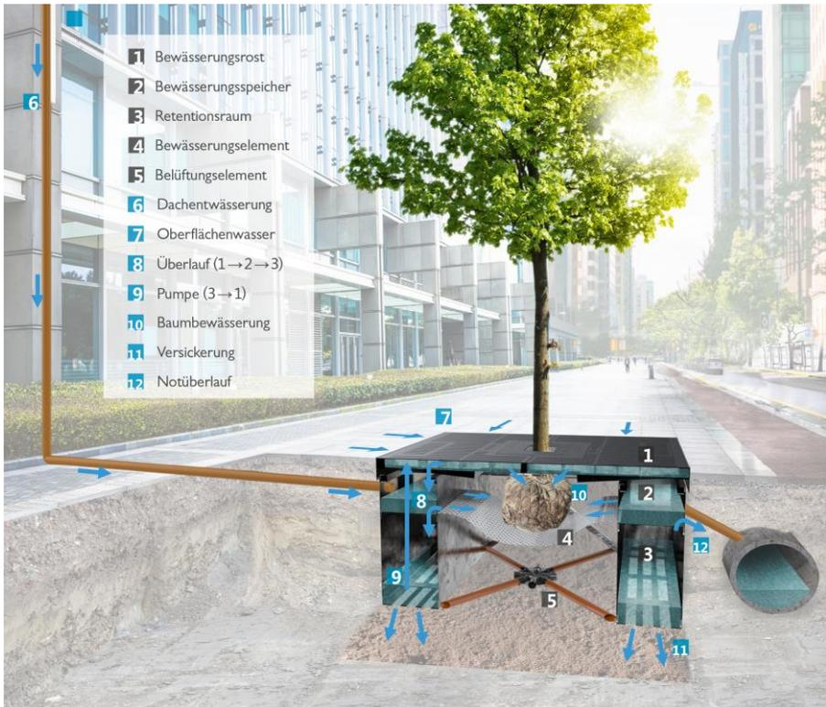
Abb. 2: Darstellung des prinzipiellen Aufbaus des ALVEUS-Systems (Fa. Humberg)
