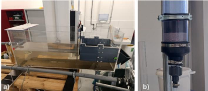
Abb. 4: a) Modellbecken im Maßstab 1:10; b) Filtersäule des Säulenversuches
