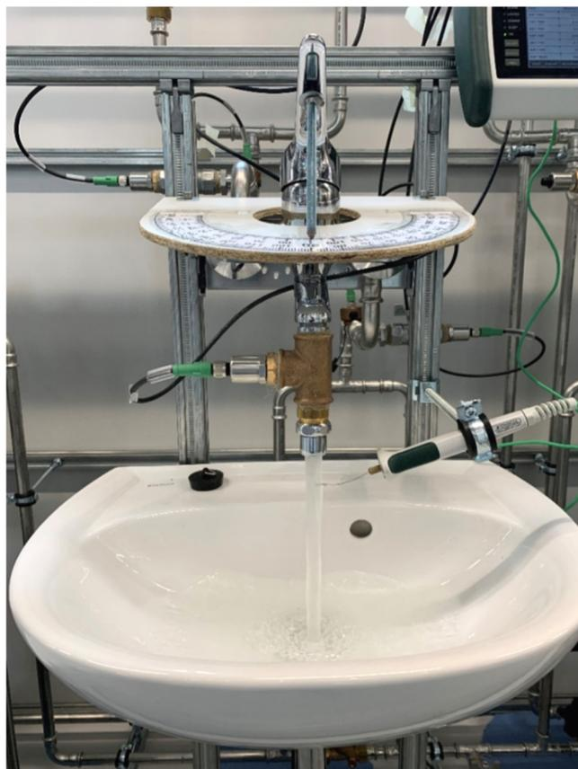
Abbildung 7-1: Versuchsaufbau zum Einfluss der Armaturentechnik auf Temperaturschwankungen
