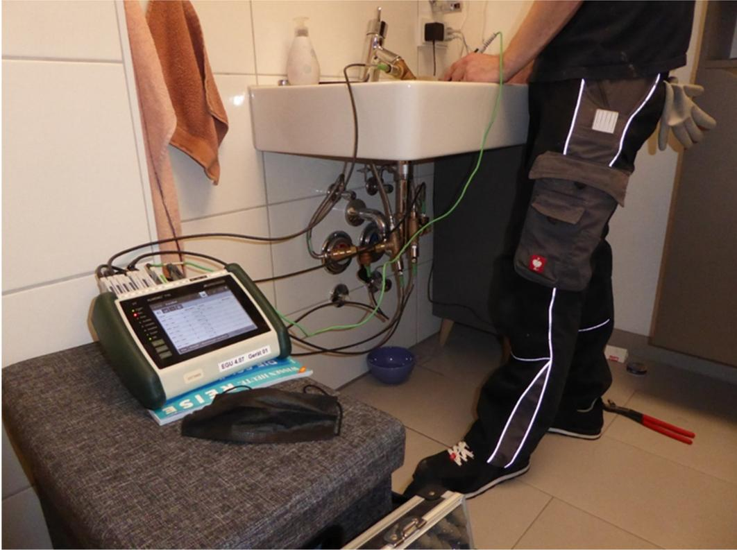
Abbildung 10-4: Druck-, Temperatur- und Volumenstrommessungen an einem WT-Einhebelmischer (Standarmatur)
