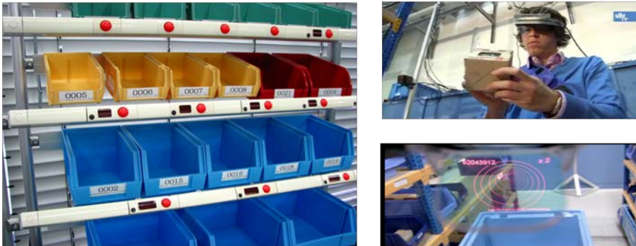
Abbildung 12: Pick to light (links) und Pick to vision (rechts) 37
