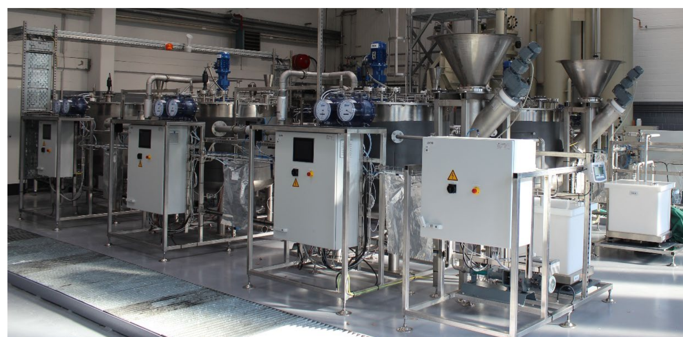
Zweistraßige Einkubikmeter Versuchsbio-gas-anlage in den Versuchshallen der FH Münster in Saerbeck
