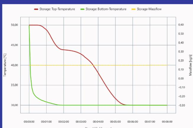
Abbildung 2: Simulation der Speichertemperaturen, während des Entladevorganges eines untersuchten Speichers mit PCM-Objekten
