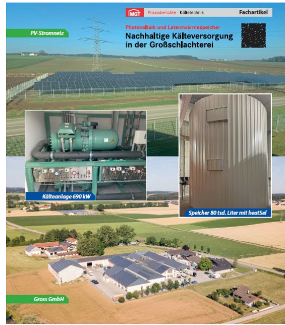
Abbildung 5: Geflügelschlachtereie, die mittels hybrider Latentspeichertechnologie, PV-Strom in Form von Kälte zwischenlagert
