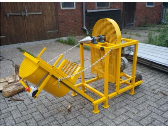
Abbildung 4: Prototyp des Kegelholzspalters von Andrej Brakk
