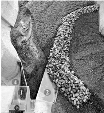
Abbildung 5: Einlaufbereich des Umleitstollens mit Leitkonstruktion. Blick in Richtung oberstrom. 1) Einlaufbereich 2) Öffnung in der Leitkonstruktion 3) Leitkonstruktion als Schüttdamm 4) Verfüllung der Ausbuchtung auf der rechten Talflanke
