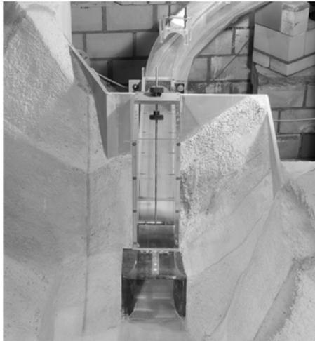
*Abbildung 2: Einlaufbauwerk mit anschliessendem Geschiebeumleitstollen*
