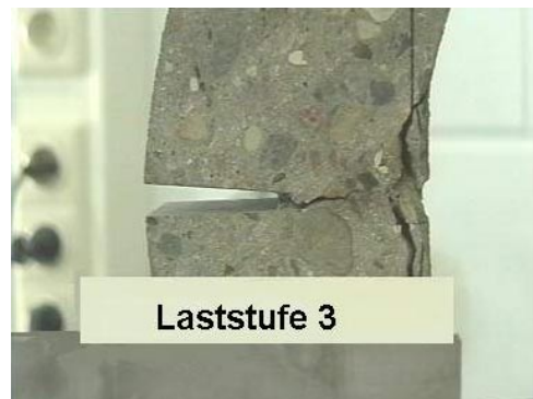
Bild 8 Überprüfung der Grenztragfähigkeit der Altrohrdruckzonen durch Versuche (aus [4], neues Betonrohr, w_{GR,v} = 9\% )
